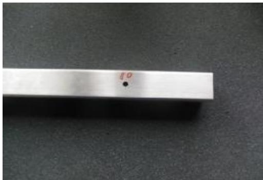
2. Startbohrung mit Spiralbohrer Ø5mm bohren.
