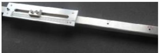
5. Bohrung in der Bohrbuchse der Bohrlehre mit Spiralbohrer Ø5mm bohren
