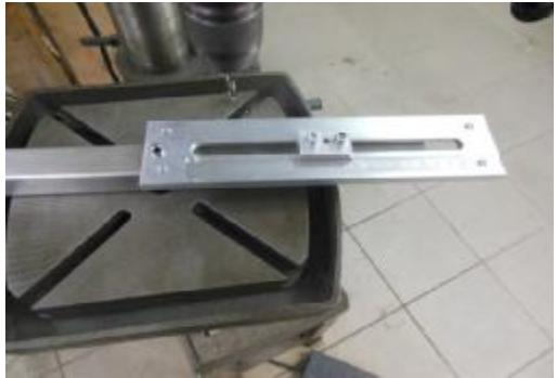
4. Den Zentrierstift in die 5mm Startbohrung einführen und die Bohrlehre plan auf das Rohr auflegen.
