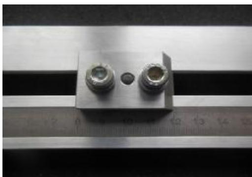
3. Bohrlehre an der Abgeschrägten Seite auf benötigten Bohrungsabstand einstellen und die beiden Innensechskantschrauben M6 mit Winkel-Sechskantschraubendreher 5mm klemmen.
